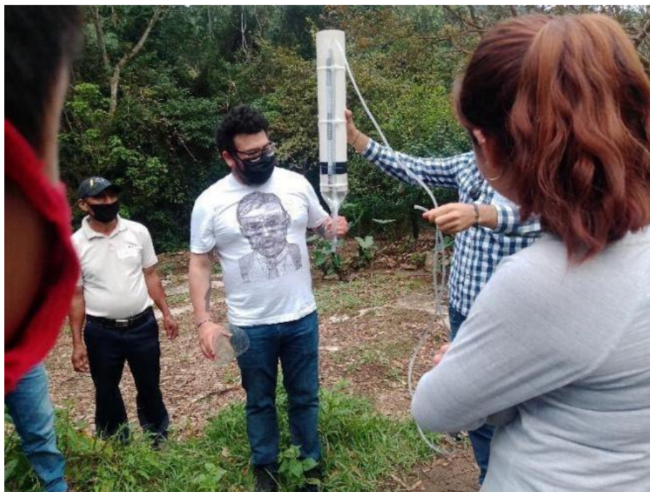
Foto 6. Muestra de funcionamiento y registro de pluviómetro casero.
