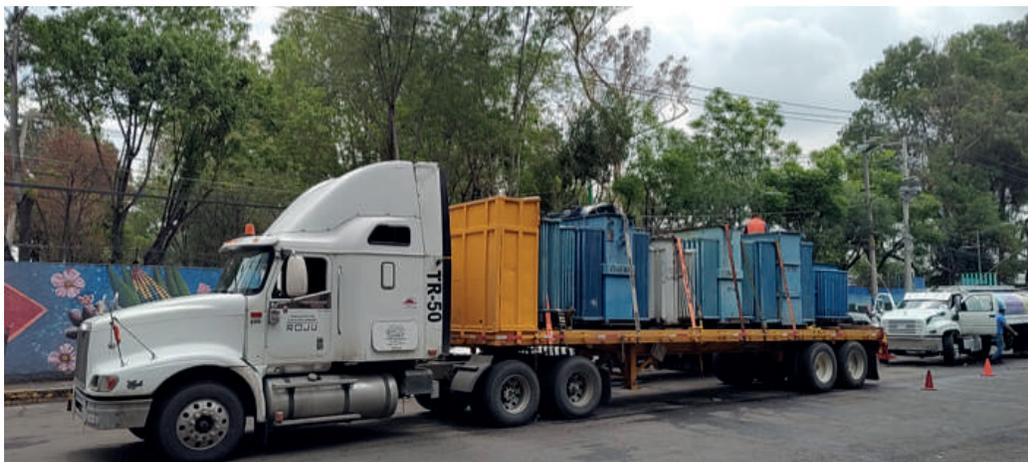
Imagen 5. Recolección y transporte de un transformador contaminado con BPCs.
